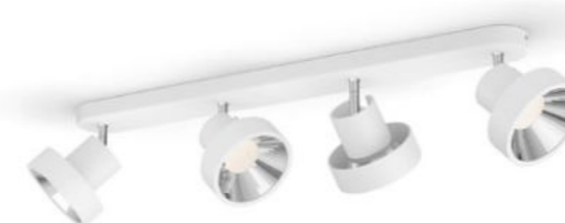
BUKKO BAR/TUBE WHITE 4X4.3W SELV 5060431P0 8718696169582 ↔ 754 / 110 | 170 mm 4x4,3 W, 1600 lm - 2700 K Választható színhőmérséklet 2200 / 2500 / 2700K
